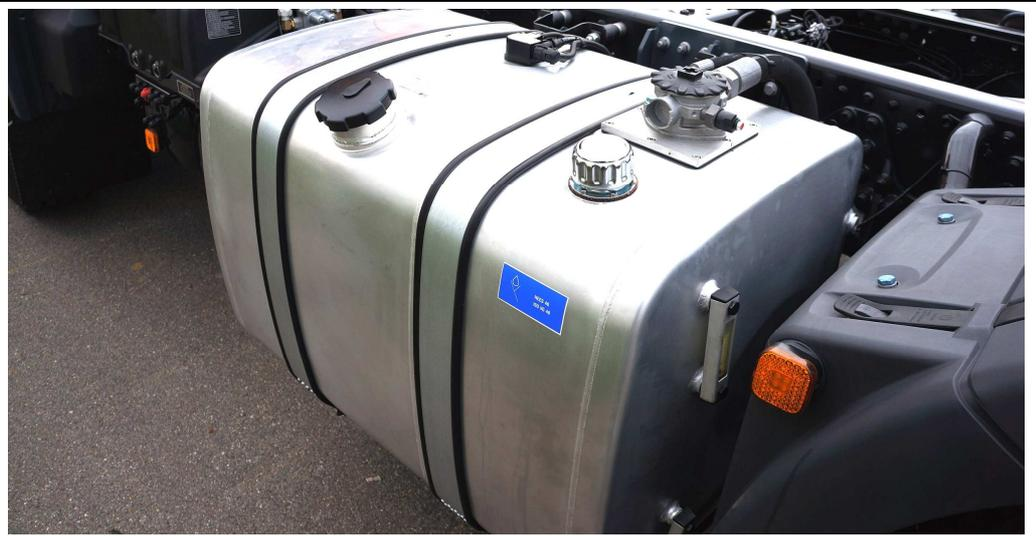
➤ **Kombi-Kraftstoffbehälter** mit 150 l Hydrauliköltank MAN-Code 023RQ und Staudruckanzeige am Rücklaufilter.
