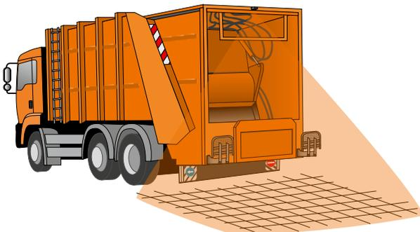
Vertikale Erfassung des Rückraums beispielsweise bei Entsorgungsfahrzeugen, Öffnungswinkel 100° oder 120°
